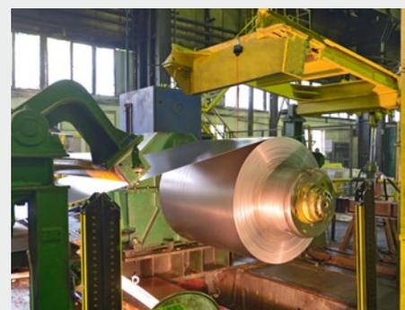
Rilevamento di diametri delle bobine
