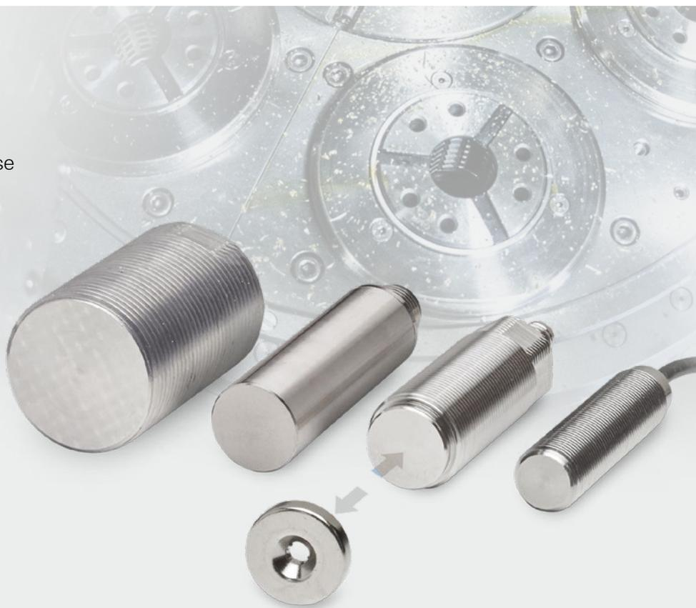
I sensori di distanza mainSENSOR sfruttano un principio di misura innovativo che unisce i vantaggi dei sensori induttivi e di quelli magnetici. Il sensore misura la distanza da un magnete che viene fissato al target ed emette un segnale di uscita lineare continuo. Con l'impiego di magneti di diversa intensità è possibile realizzare campi di misura tra 20 e 55 mm. Per modificare il campo di misura si deve solo sostituire il magnete.
