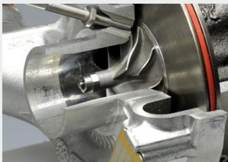
Misurazione della velocità di rotazione dei turbocompressori
