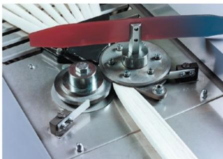
Misurazione dello spessore del filato in linea
