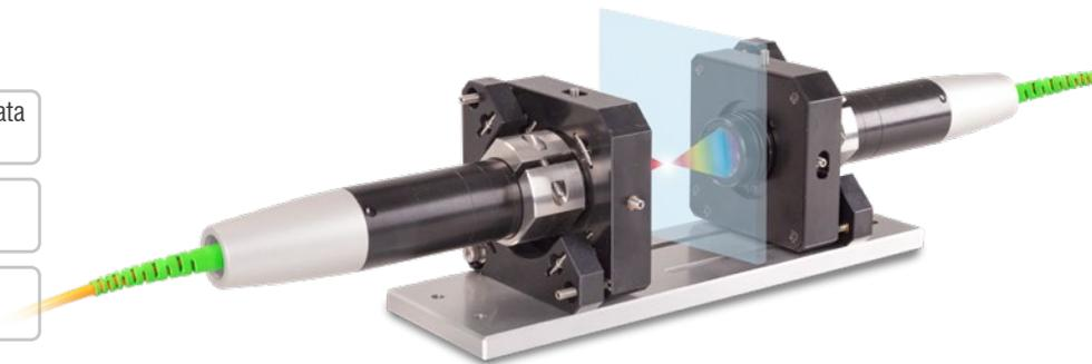
Per le misure di spessore su due lati, l'adattatore di montaggio JMA-Thickness consente di allineare i punti di misura l'uno all'altro. In questo modo, i punti di misura sono disposti in modo assolutamente congruente, in modo che i sensori si trovino esattamente su un asse ottico. Ciò evita misure sfalsate e permette di ottenere un risultato affidabile con la massima precisione possibile.
