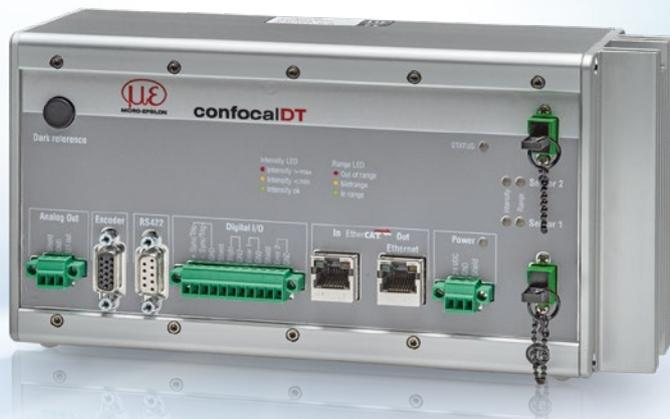
I controller confocalDT 2421 e 2422 dettano lo standard industriale nella metrologia confocale di precisione. Nella variante a uno o due canali, i sistemi di misurazione cromatici confocali sono una soluzione conveniente soprattutto per le applicazioni in serie. La regolazione attiva dell'esposizione della matrice CCD consente una compensazione rapida e precisa di varie superfici.
