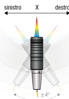
❸ Max. ribaltamento in X \pm 4^\circ
