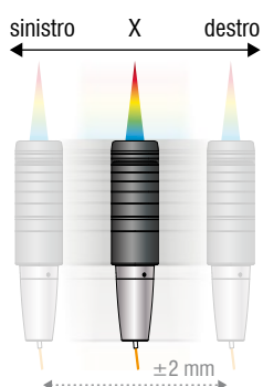
❶ Max. spostamento in X \pm 2 mm
