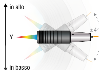
❹ Max. ribaltamento in Y \pm 4^\circ
