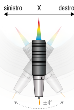
❸ Max. ribaltamento in X \pm 4^\circ
