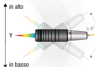
❹ Max. ribaltamento in Y \pm 4^\circ
