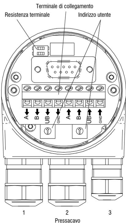
Cavi: 1, 2 =  $\varnothing$ 8 - 10 mm (-40 - 85 °C) /  $\varnothing$ 5 - 9 mm (-25 - 85 °C)
