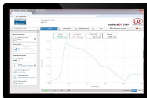
Tutte le impostazioni vengono eseguite tramite l'interfaccia web. Per la misurazione dello spessore è presente un database dei materiali che può essere ampliato a piacimento.
