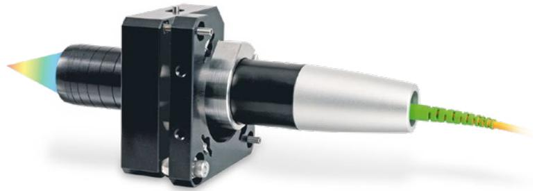
Soprattutto per i sensori ad alta risoluzione con un angolo di inclinazione ridotto è richiesto un fissaggio ortogonale. L'adattatore di montaggio JMA-xx consente l'allineamento preciso del sensore rispetto al target grazie al semplice meccanismo di regolazione. In questo modo è possibile compensare facilmente piccole deviazioni di montaggio o inclinazioni del target.
