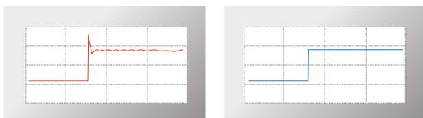
La media dei valori misurati in due fasi consente di ottenere curve di segnale uniformi quando si misurano i bordi (destra), altrimenti verranno generati segnali di interferenza (sinistra).
