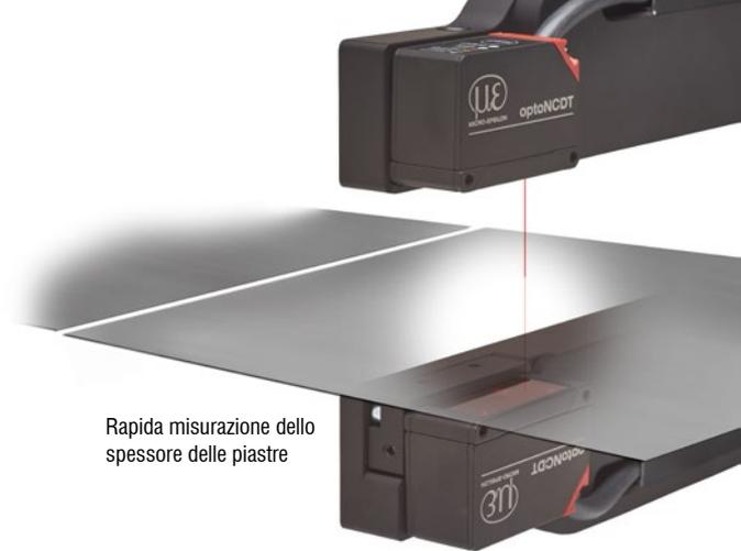
Rapida misurazione dello spessore delle piastre
