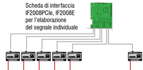
**Dual Processing Unit: Controller per la conversione D/A e il calcolo di max. 2 segnali dai sensori**
