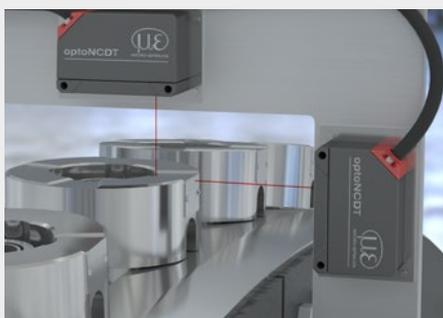
Controllo dimensionale di pezzi torniti
