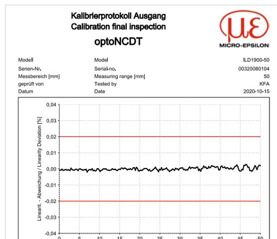
Ogni sensore viene testato e fornito con un protocollo di calibrazione che ne documenta le prestazioni. Tale documento è incluso nell'ambito di fornitura o può essere consultato tramite l'interfaccia web.
