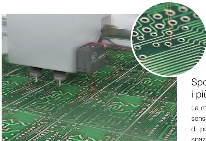
Spot di misura da  $8,5 \times 11 \mu\text{m}$  per catturare i più piccoli dettagli
